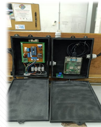
COLMENA INTELIGENTE EQUIPADA CON SENSORES Y TECNOLOGIAS DE MONITOREO EN TIEMPO REAL (Articulación intercentros)
